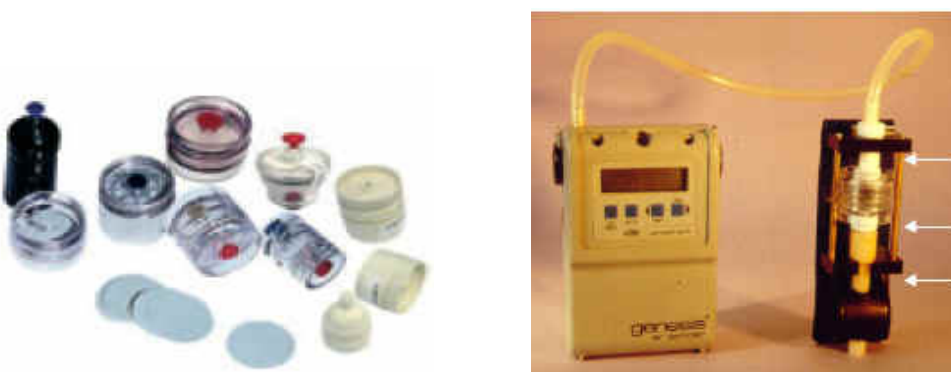
Figure 15 -Différents modèles de cassettes à filtre et dispositif complet de prélèvement comportant un sélecteur de type cyclone Dorr Oliver.
